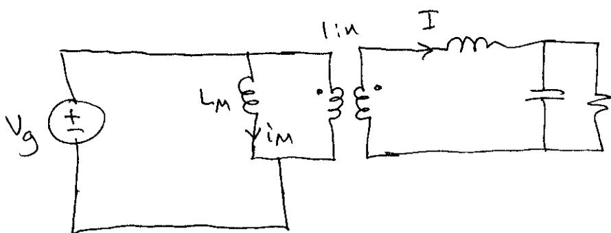
$$\frac{di_m}{dt} = \frac{V_g}{L_M}, \quad i_{M1} = -i_{m0} + \frac{V_g t_1}{L_M} \Rightarrow t_1 = (i_{M1} + i_{m0}) \frac{L_M}{V_g}$$
