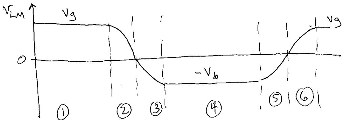
$$\langle v_{LM} \rangle = 0 \Rightarrow \langle v_{ds} \rangle = V_g$$
