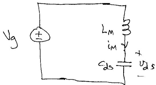
initial  $v_{ds} = V_g$ ,  $i_m = i_{M2}$
